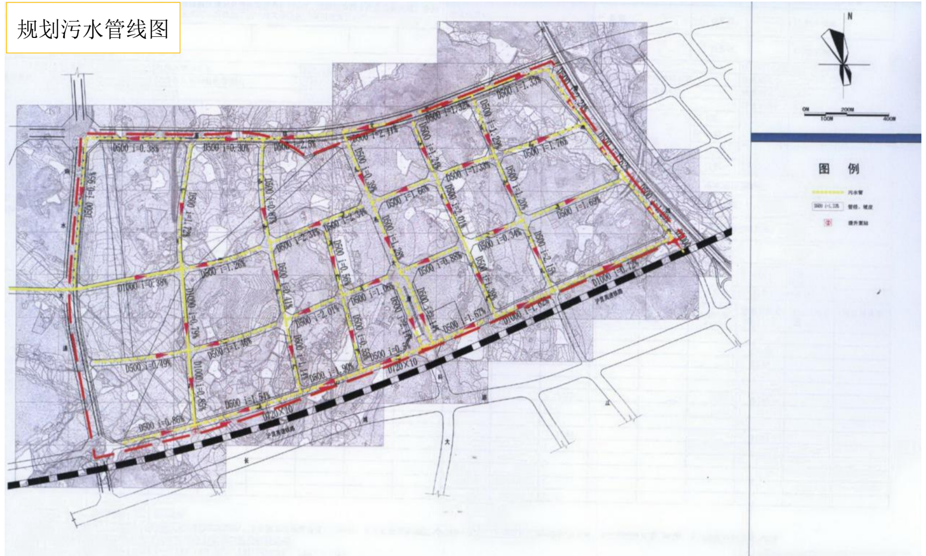
附图 6-2 综保区雨污排水分区图-污水
